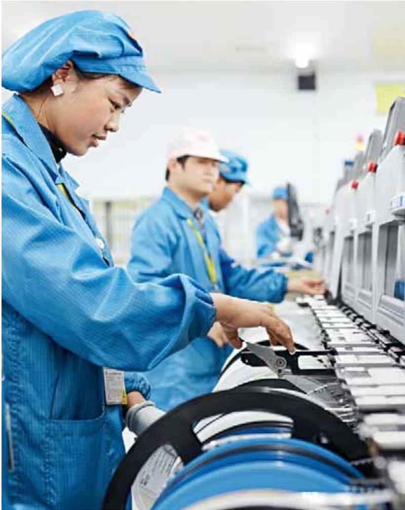
Mitarbeiter an den automatischen Bestückungslinien bei HELLA Shanghai Electronics. Jährlich verlassen rund 35 Mio. bestückte Leiterplatten die Produktionshallen des Werkes.
