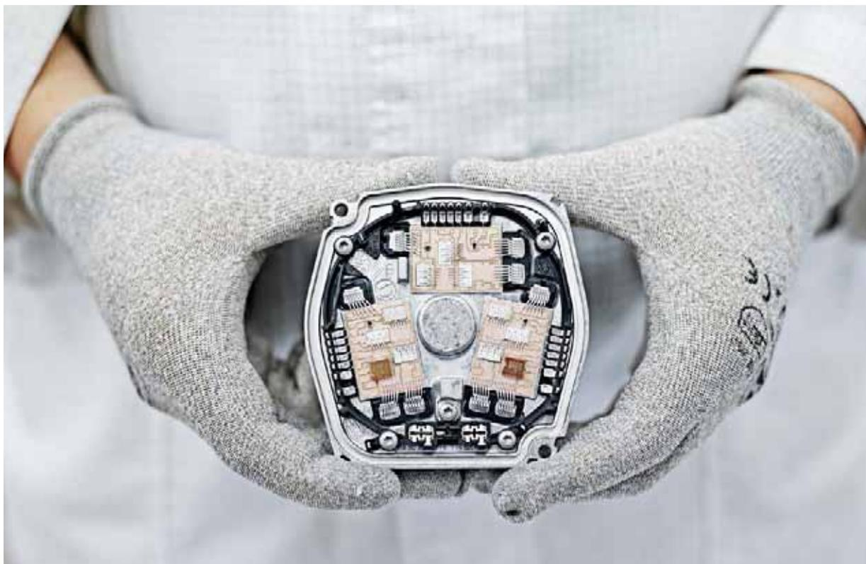
Die offene Halbleiterverarbeitung ist einer der Arbeitsschritte im Produktionsprozess der elektrischen Lenkkraftunterstützung (EPS).
